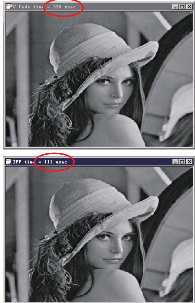
그림 12: 이 이미지 조정 예에서(256x256비트에서 460x332비트로) 인텔® IPP 사용 응용 프로그램의 경우 실행 시간이 111 ms인 것에 반해, 컴파일된 C++ 코드의 경우에는 실행 시간이 338 ms이었습니다(시스템 구성: 인텔® 제온, 2.9 GHz, 2개 프로세서, 프로세서당 4개 코어, 프로세서당 2개 스레드)
